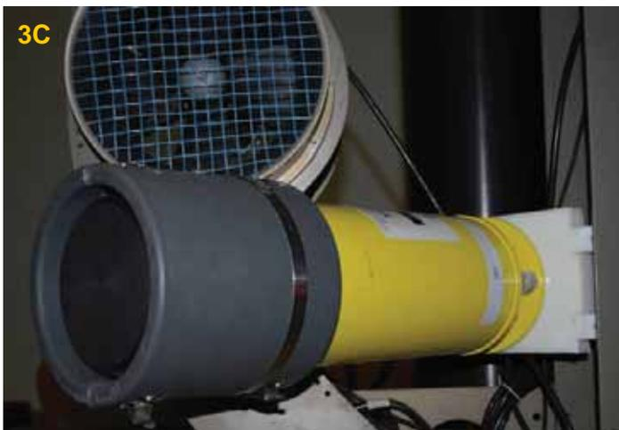
Figure 3: Primary navigation sensors: 3A) IMU/RLG ; 3B) resonant oscillator depth sensors; 3C) iUSBL
