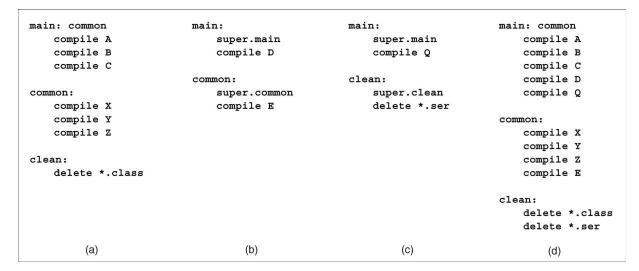
Fig. 5. Makefiles, refinements, and composition. (a) base makefile, (b) foo refinement, (c) bar refinement, (d) bar(foo(base)).
