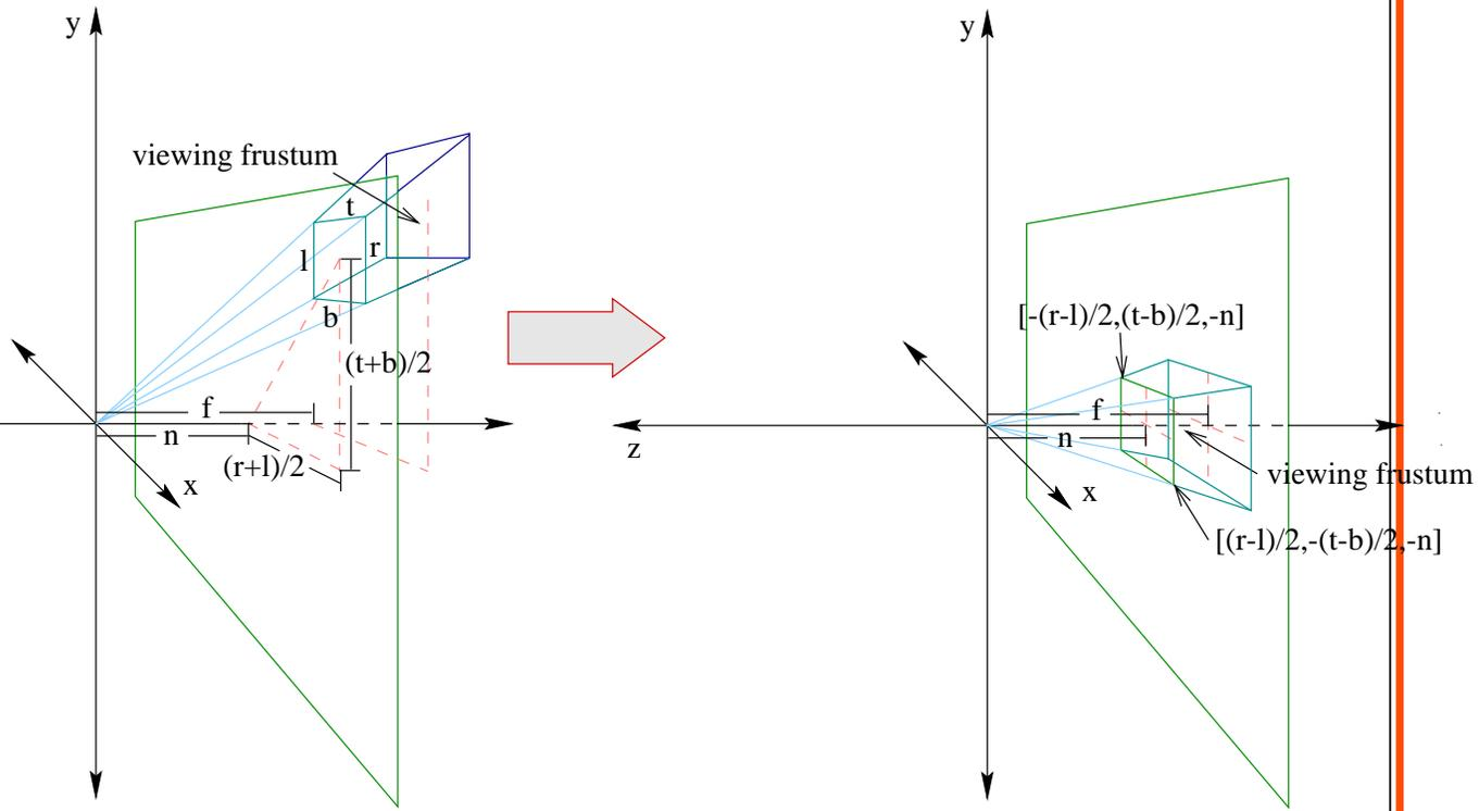
$$\begin{bmatrix} x' \\ y' \\ z' \\ 1 \end{bmatrix} = \begin{bmatrix} 1 & 0 & \frac{r+l}{2n} & 0 \\ 0 & 1 & \frac{t+b}{2n} & 0 \\ 0 & 0 & 1 & 0 \\ 0 & 0 & 0 & 1 \end{bmatrix} \begin{bmatrix} x \\ y \\ z \\ 1 \end{bmatrix}$$
