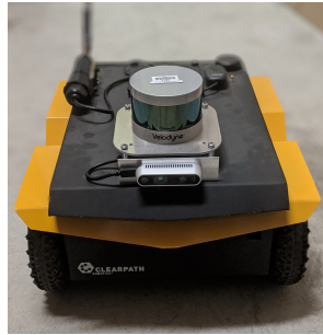
Robot: Clearpath Jackal (Velodyne Puck lidar)
