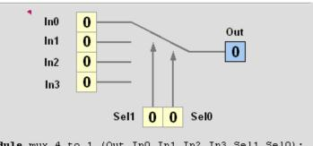
module mux\_4\_to\_1 (Out,In0,In1,In2,In3,Sel1,Sel0);
